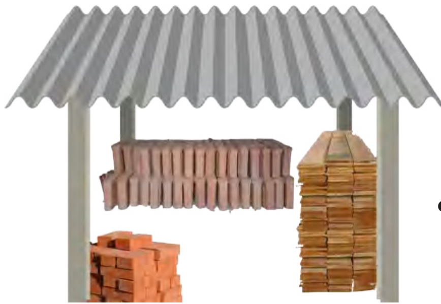
Material de construção organizado e coberto
