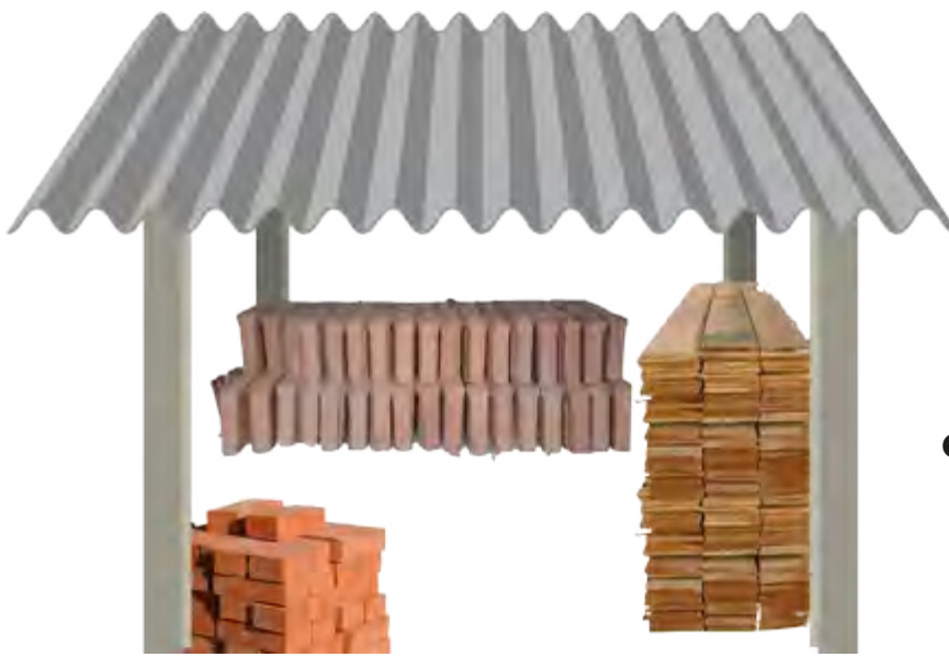
Material de construção organizado e coberto
