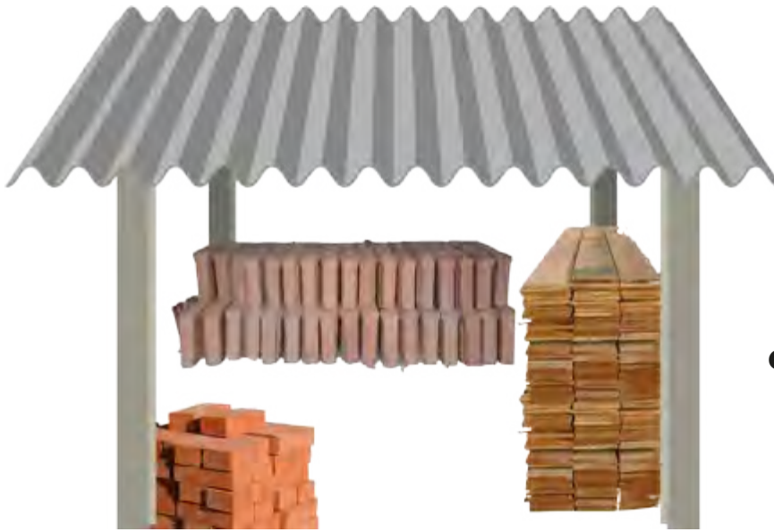
Material de construção organizado e coberto
