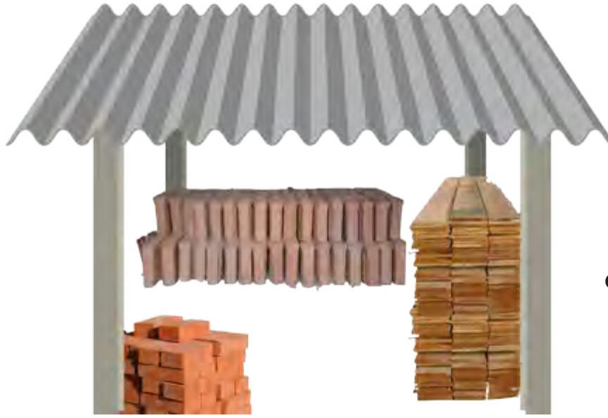
Material de construção organizado e coberto
