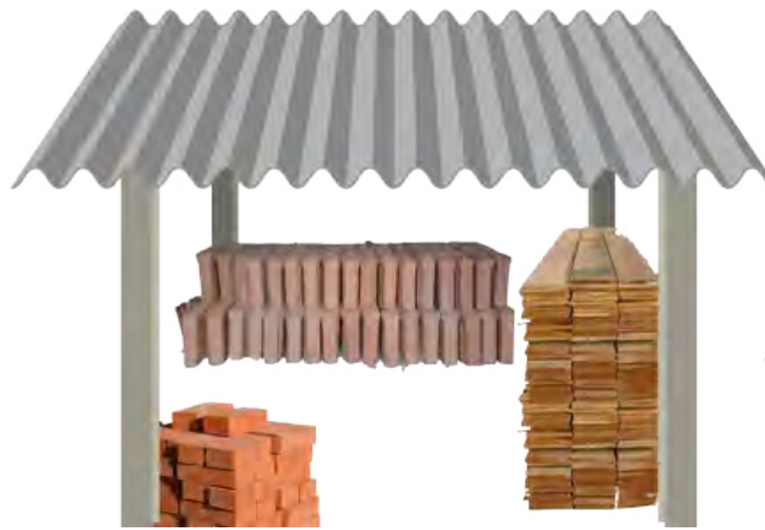
Material de construção organizado e coberto
