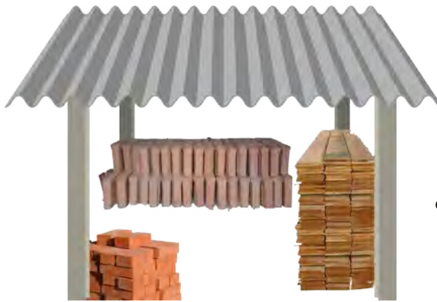
Material de construção organizado e coberto
