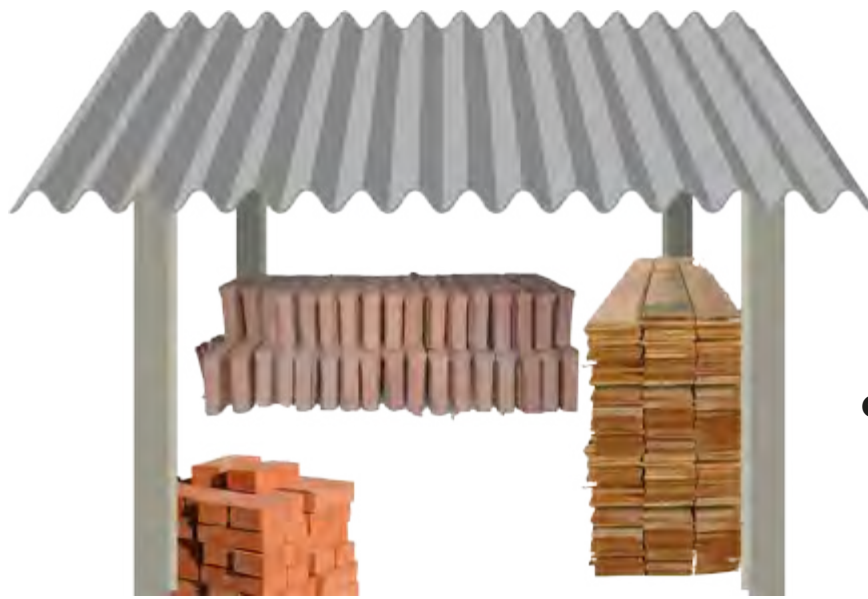
Material de construção organizado e coberto
