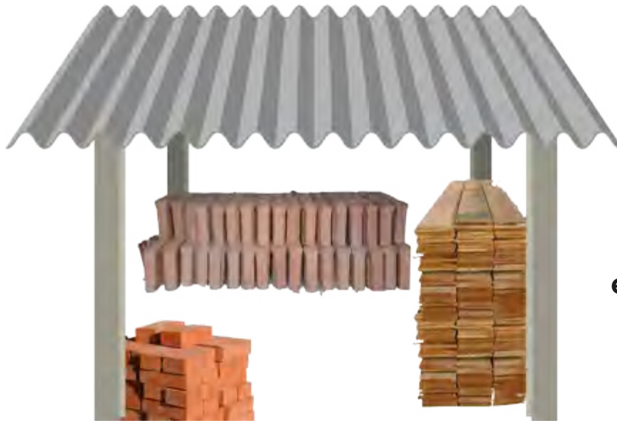
Material de construção organizado e coberto
