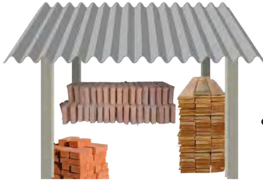
Material de construção organizado e coberto
