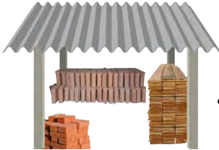
Material de construção organizado e coberto
