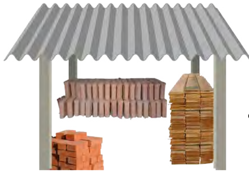
Material de construção organizado e coberto
