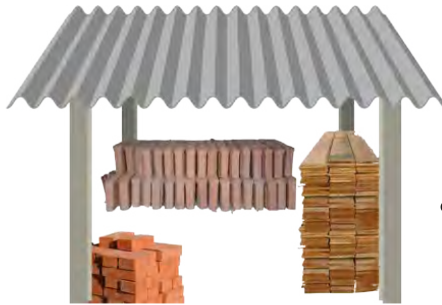
Material de construção organizado e coberto
