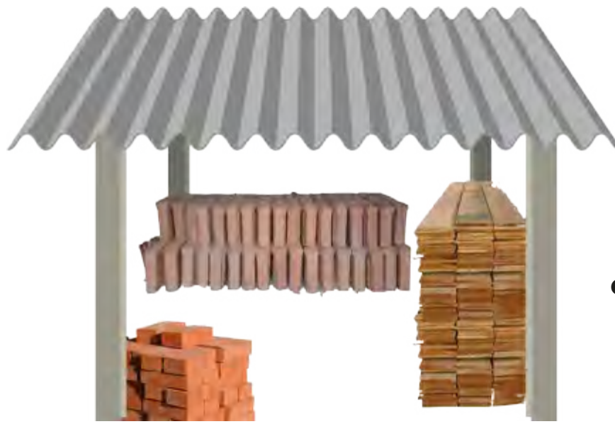
Material de construção organizado e coberto
