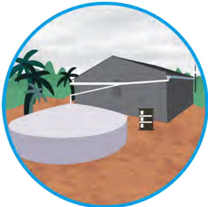
Coleta e armazenamento adequado da água da chuva
