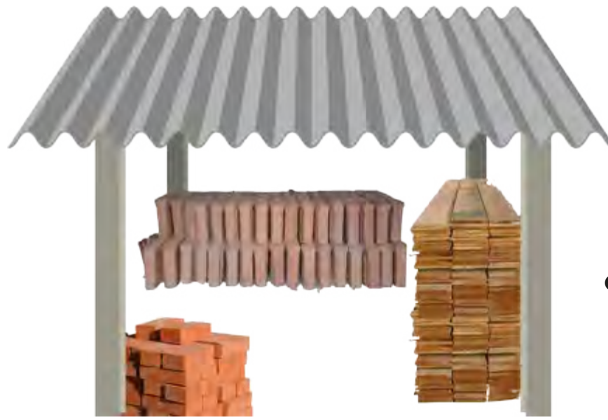
Material de construção organizado e coberto
