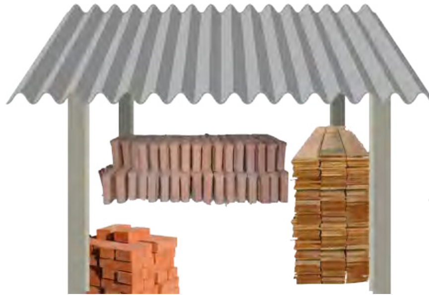
Material de construção organizado e coberto
