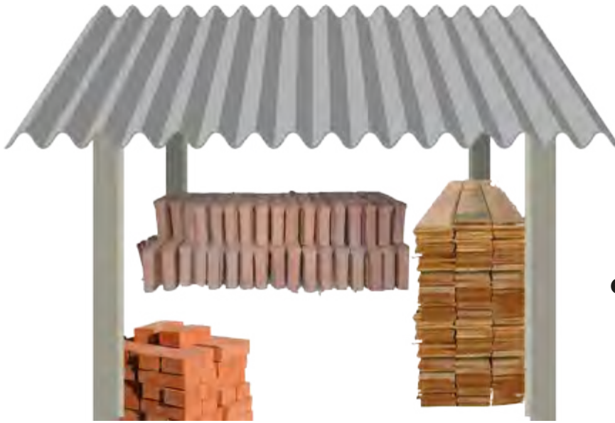
Material de construção organizado e coberto
