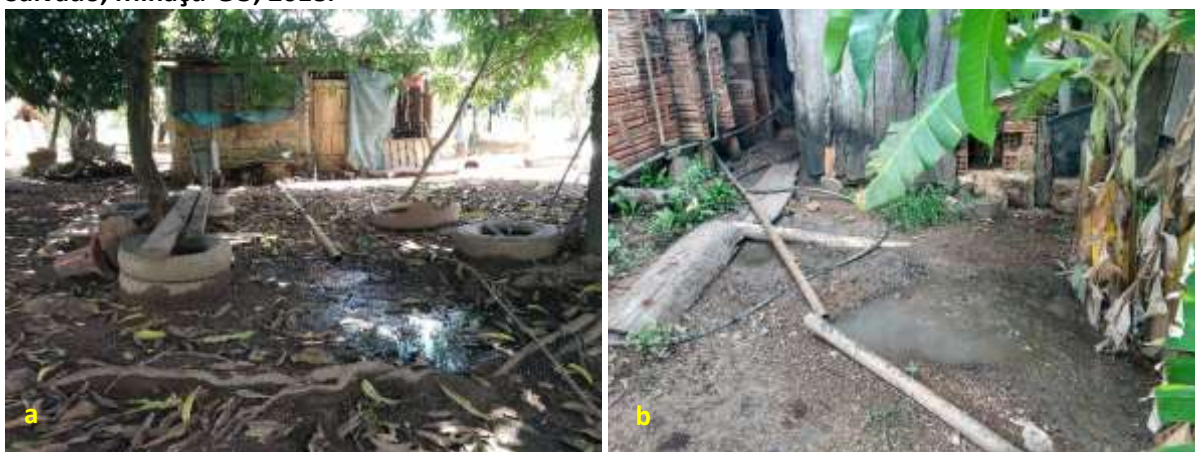
Foto 6.9 – Lançamento e acúmulo de água cinza proveniente da pia da cozinha e/ou do tanque de lavar roupas, diretamente no solo do quintal próximo aos domicílios (a) e (b), na Comunidade São Salvador, Minaçu-GO, 2018.
