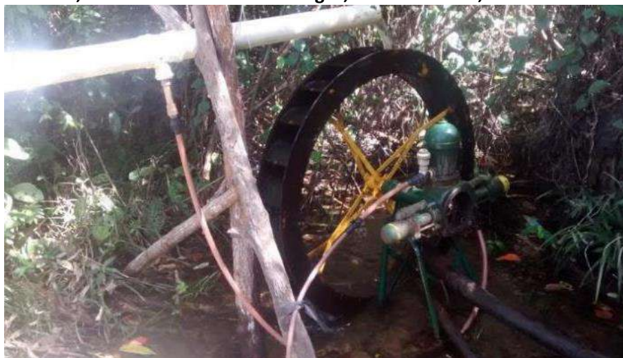
Foto 6.6 – Captação de um sistema alternativo, composto por uma roda d'água que abastece a escola, a Igreja Católica e a Assembleia de Deus, além de contribuir com o abastecimento de água em alguns domicílios, na Comunidade São Domingos, Cavalcante-GO, 2019.
