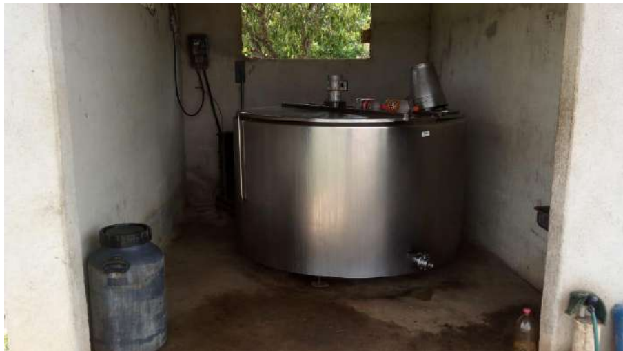
Foto 4.1 – Tanque de resfriamento de leite identificado na Comunidade Santo Antônio das Areias, Faina-GO, 2018.
