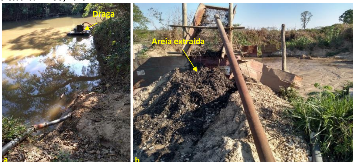
Foto 6.20 – Draga utilizada para extração de areia (a) e areia extraída (b) na Comunidade Rochedo, Professor Jamil-GO, 2018.
