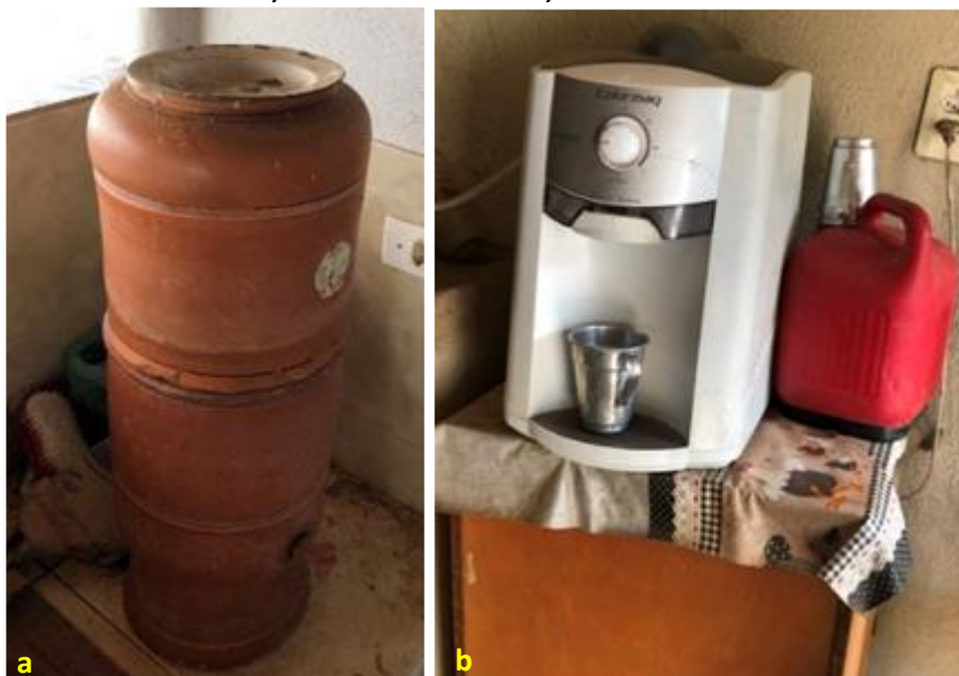
Foto 6.7 – Filtro cerâmica porosa (vela) (a) e filtro elétrico (b) utilizados para filtrar a água para ingestão na Comunidade Rochedo, Professor Jamil-GO, 2018.
