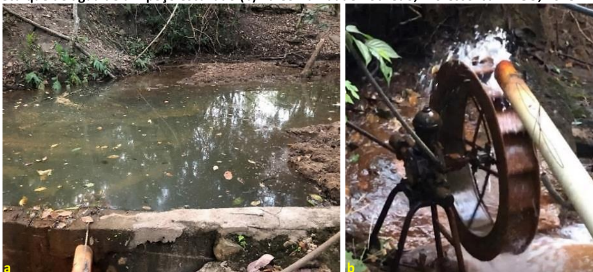
Foto 6.4 – Represamento utilizado para alimentar a roda d’água (a) e a roda d’água utilizada para recalque de água de um poço escavado (b) na Comunidade Rochedo, Professor Jamil-GO, 2018.
