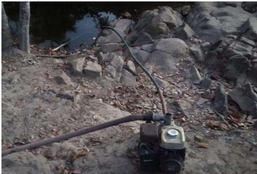
Foto 6.5 – Captação realizada em manancial superficial para atender um domicílio da Comunidade Capela, Cavalcante-GO, 2019.
