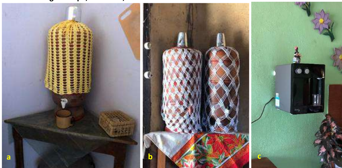
Foto 6.8 – Filtração e realização por filtro cerâmica porosa (a e b) e por filtro elétrico (c), na Comunidade Água Limpa, Faina-GO, 2019.
