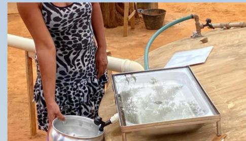
Por suas características de durabilidade, baixo custo de manutenção, simplicidade de operação e eficiência, o Aqualuz® configura-se como um sistema de desinfecção adequado a atender a demanda por água (consumo humano) de famílias de regiões áridas e semiáridas.
